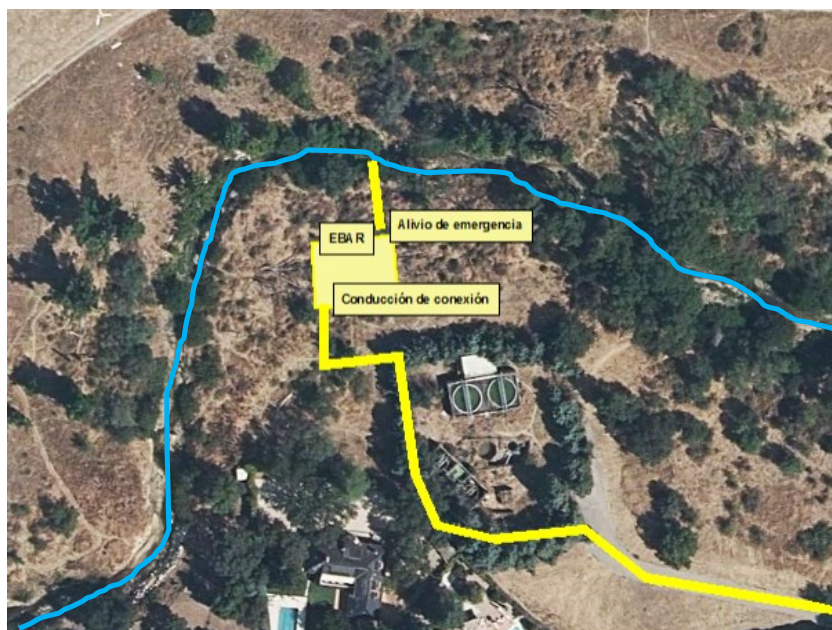
Figura 4. Situación de la EBAR y alivió de emergencia respecto al arroyo Viñuelas (Fuente: SITTAjo)
