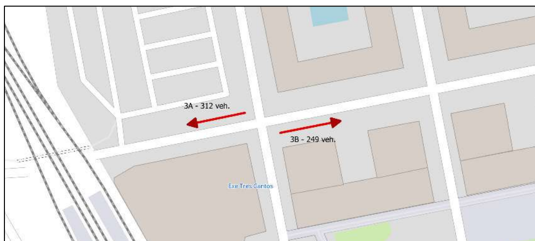
Gráfico 21. Plano de Intensidades aforadas en punto de aforo 3 a las 19:00 h.
