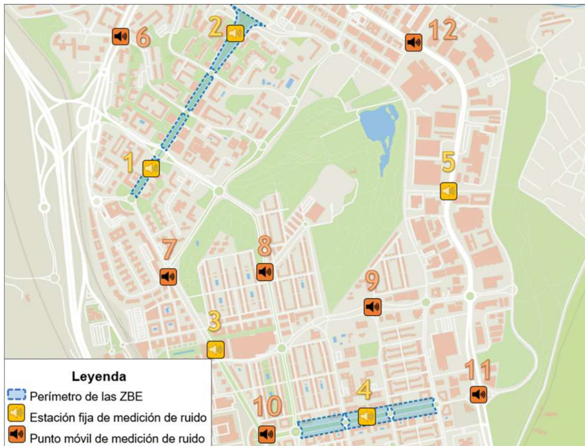
Gráfica 112. Plano de ubicación de los sistemas de medida de contaminación acústica propuestos.
