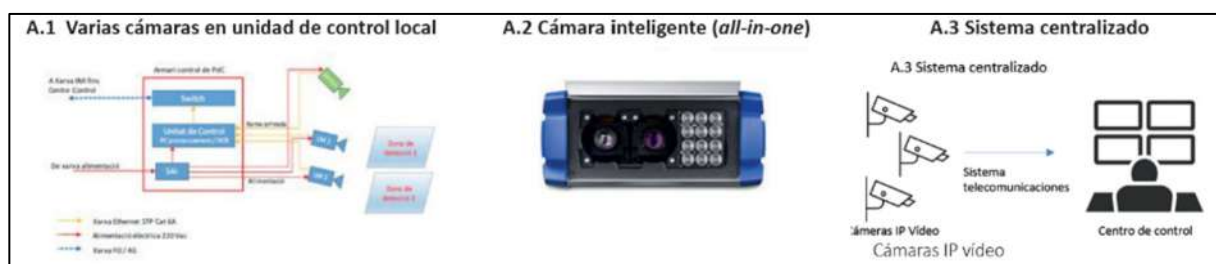
Gráfica 100. Diferentes arquitecturas del sistema de cámaras de control.
