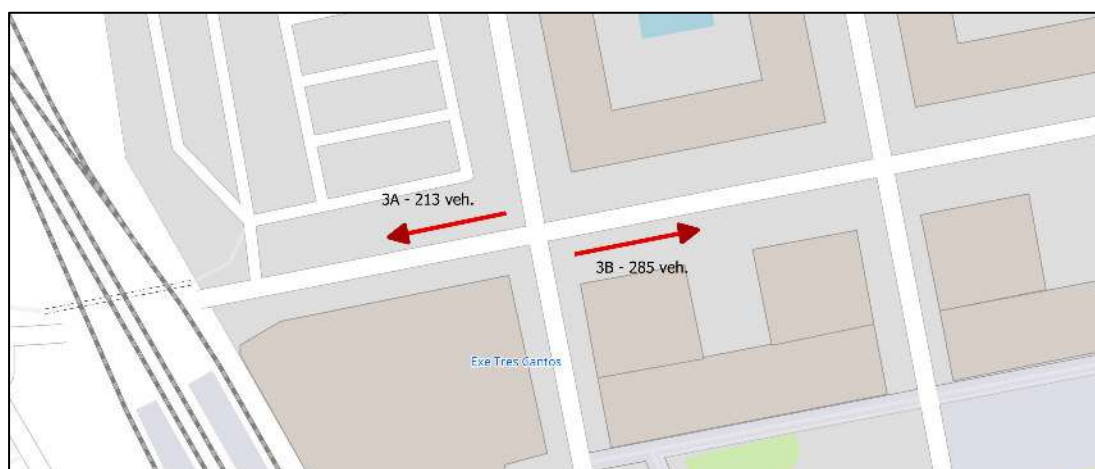
Gráfico 20. Plano de Intensidades aforadas en punto de aforo 3 a las 13:00 h.
